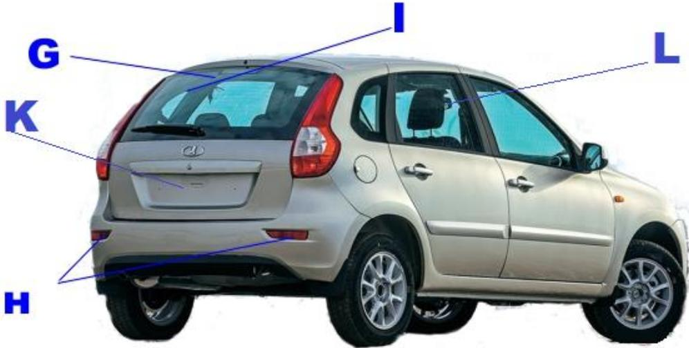
Рис. 3 Схема расположения обязательных наклеек на автомобиле. Вид  $\frac{3}{4}$  сзади.
